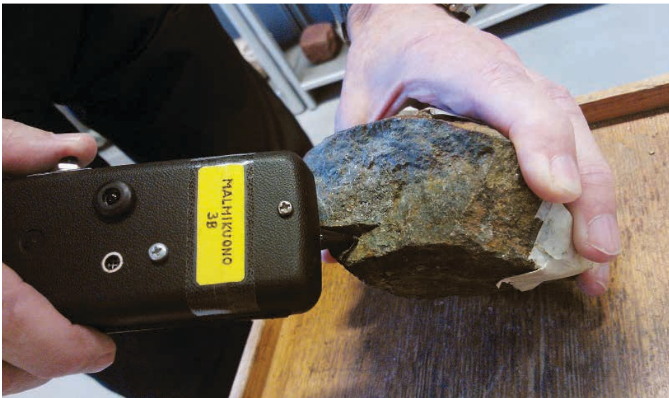
Malmikuono 3B. Laitte on taskukokoinen. Laitteen pituus on 16 cm ja leveys 6 cm. Kuva: Satu Hietala, GTK.
